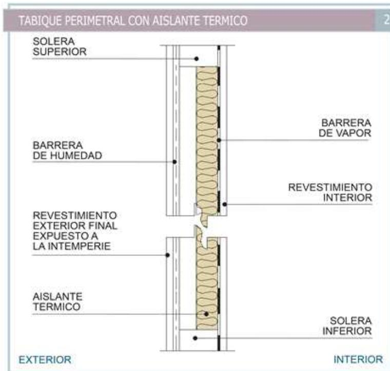
Figura N° 3 Detalle constructivo muros interiores
